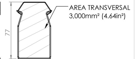
1. Fabricado en lámina de acero calibre 18 y 22.
